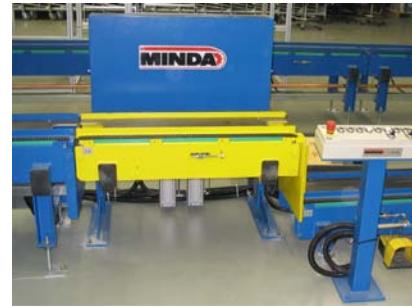
Hubstation – im abgesenkten und angehobenen Zustand
